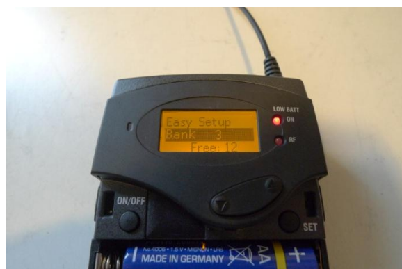
Når mikroporten har fundet en frekvens vil der i displayet stå, "Bank nr xx Free nr"
